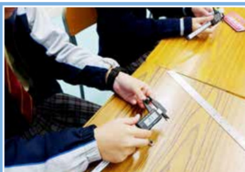
學生利用電子游標卡尺量度零件的外徑
