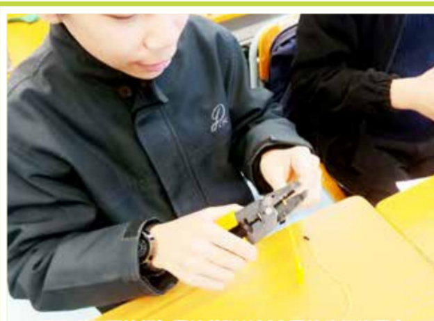
學生利用開線鉗把電線剪斷並剝去電線的絕緣膠皮
